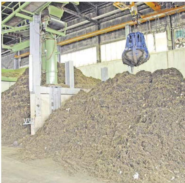
Eine vollautomatische Greifer-Einrichtung beschickt ab einem Zwischen-depot den Fermenter mit zerkleinertem Grüngut.
